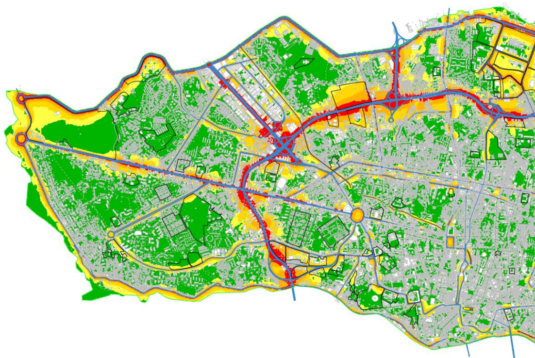
Figura 3 – Mapa de ruído produzido em 2014 – indicador L_n – porção ocidental da cidade (1 de 2).
